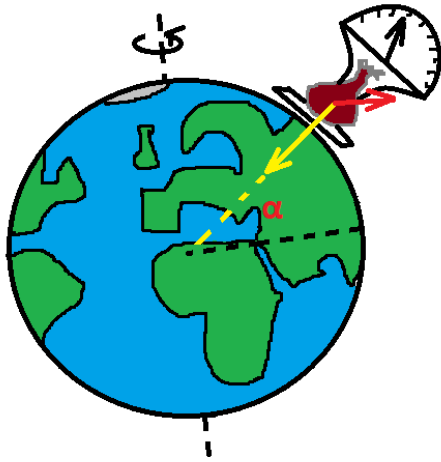
Rysunek 4: Pomiar masy na wadze. Oprócz siły ciężkości występuje też znacznie mniejsza od niej siła odśrodkowa (odpowiednio żółta i pomarańczowa strzałka).
