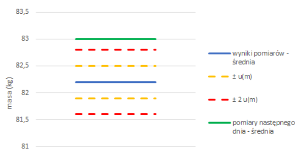
Rysunek 5: Średnia pomiarów masy z drugiego dnia różni się od poprzedniej średniej. Wynik nie mieści się w przedziale \pm u(m) (w którym znajduje się prawdziwa masa z 67% pewnością), ani w przedziale \pm 2u(m) (w którym znajduje się prawdziwa masa z 95% pewnością!)
